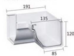
Esquina interior de 90° ANCHO 2 mm PESO 0.34 kg/pc
