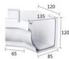
Esquina interior de 135° ANCHO 2 mm PESO 0.28 kg/pc
